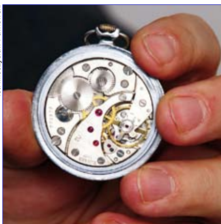
Czerwone punkty widoczne na mechanizmie to tzw. „kamienie” - inaczej - łożyska
